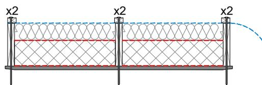
À hauteur de la sablière et des pignons, le nombre de fixations est doublé dans le cas d'un élément avec une finition en plâtre ou plâtre armé et dans le cas d'un élément avec une plaque de finition d'une épaisseur totale excédant 25 mm.
