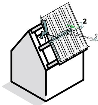
Il est conseillé de fixer entre elles les jonctions d'éléments (p.ex. au moyen de lattes de toit) avant de réaliser l'étanchéité.
