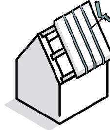
A la jonction entre panneaux il faut après mousage avec la mousse Uniflex (1), enlever la contrelatte temporaire du panneau (sans recouvrement joint) (2). Ensuite il faut enlever le film protectrice du recouvrement joint et de la membrane pour ensuite les coller (3). Finalement il faut remettre la contrelatte temporaire.
