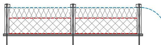
Chaque chevron est fixé au moyen d'une vis à bois qui est placée directement à travers le chevron et la plaque de base dans la construction sous-jacente.
