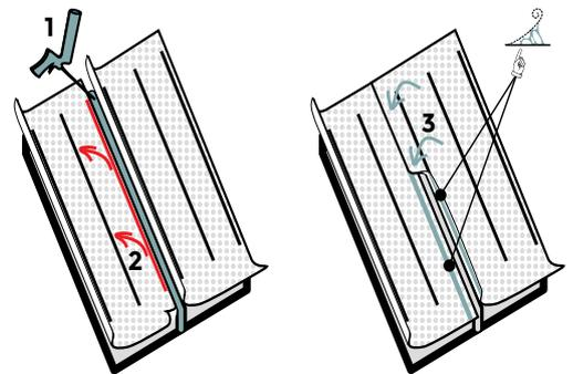
En cas de temps chaud (>21 °C) ou sec (<25 % h.r.), il est conseillé d'humidifier par vaporisation les chevrons longitudinales (qui forment la jointure longitudinale) avant le "colmatage" (de cette manière, vous limitez la quantité de produit nécessaire).
